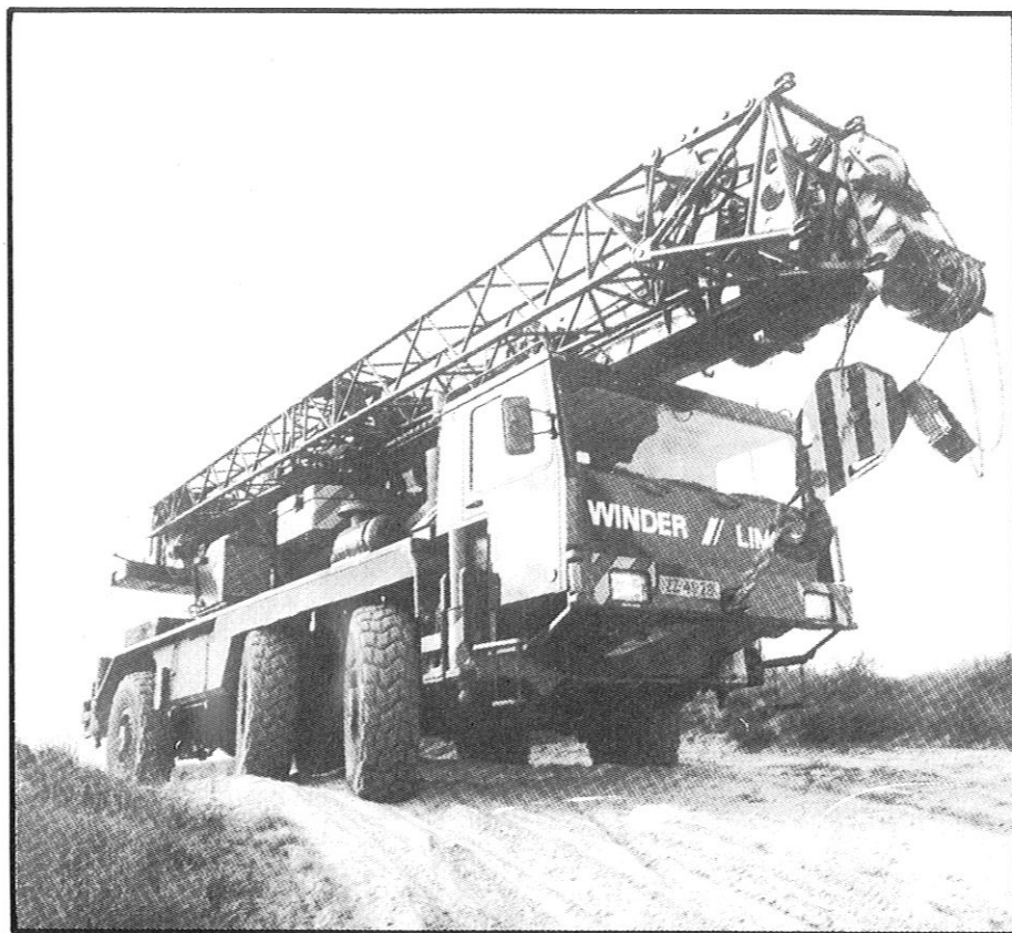
Een van de nieuwe kranen: een 50 tons ruw terrein kraan met een giek lengte van maximaal 57 meter.
